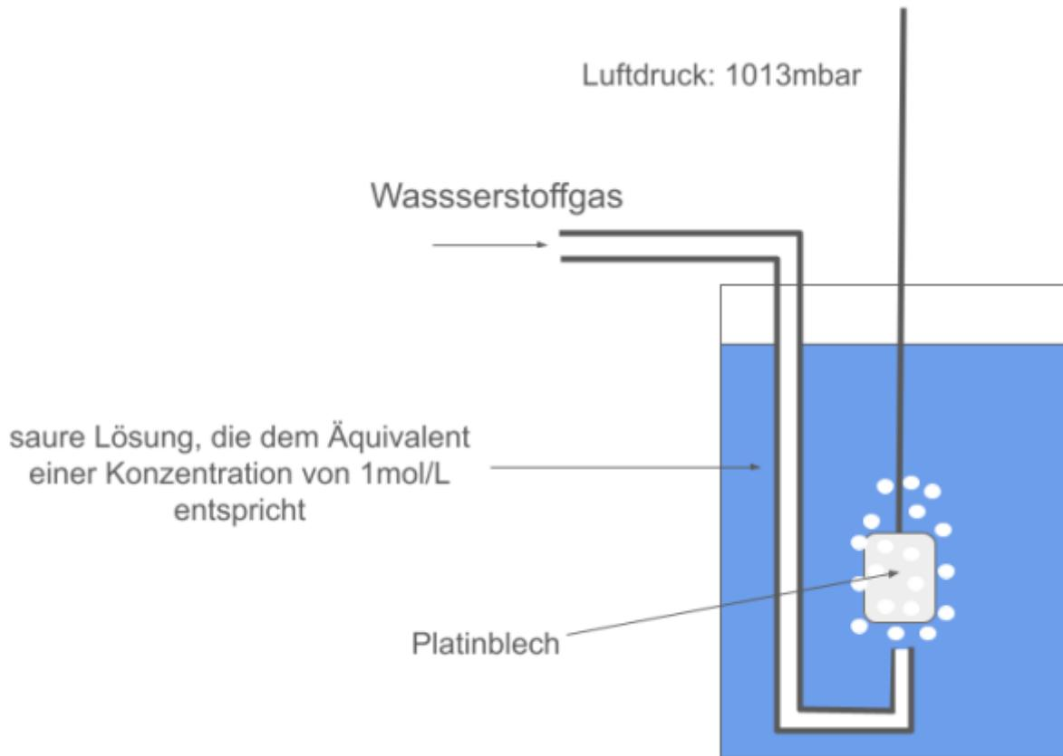
Diese Elektrode taucht in eine wässrige saure Lösung mit einer Hydroniumionenkonzentration von  $c(\text{H}_3\text{O}^+) = 1 \text{ mol/L}$  ein.
