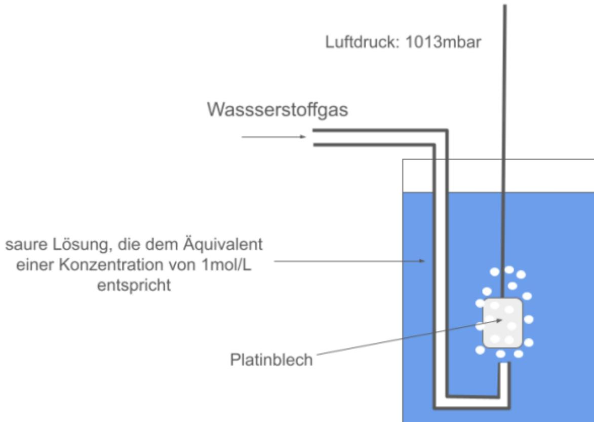
Diese Elektrode taucht in eine wässrige saure Lösung mit einer Hydroniumionenkonzentration von  $c(H_3O^+)=1\text{mol/L}$  ein.
