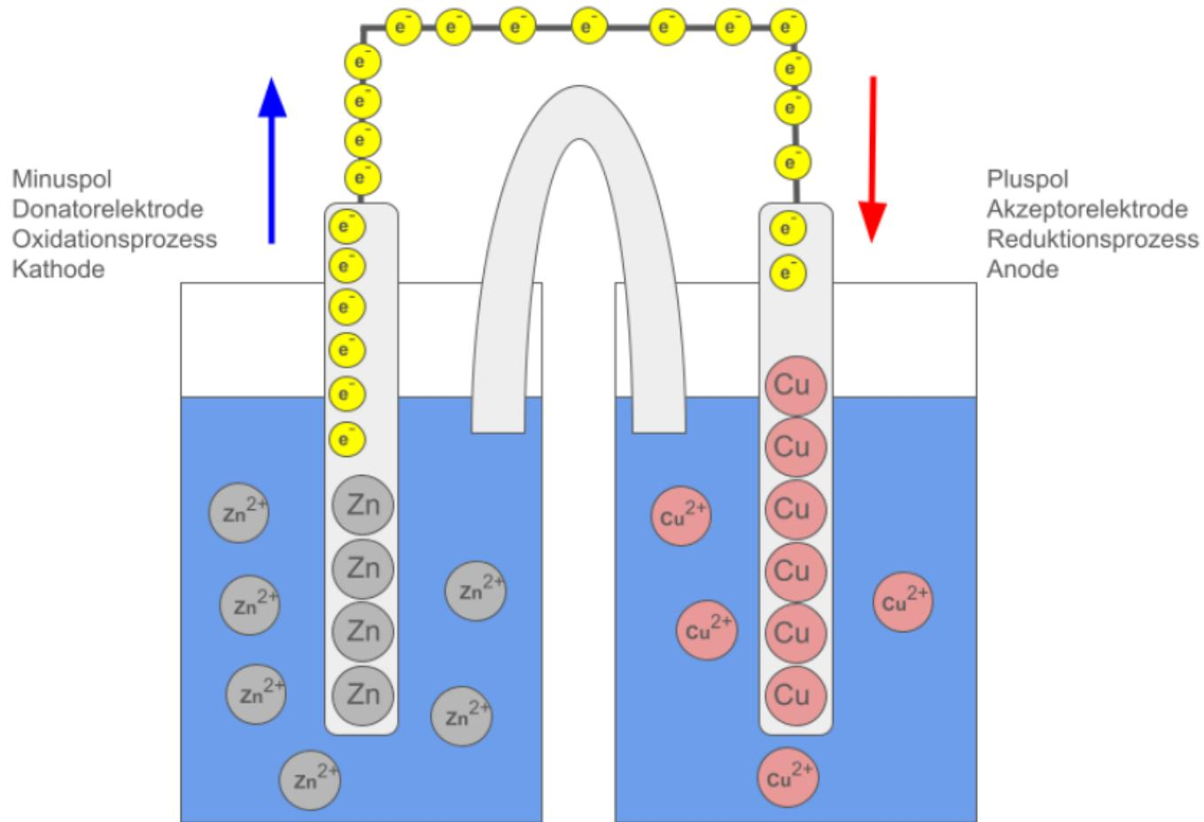
Zinkatome gehen in Lösung. Die dabei freiwerdenden Elektronen reduzieren die Kupferionen in der rechten Halbzelle zu elementarem Kupfer. Dies geschieht so lange, bis nennenwerte Mengen an Kupfersulfatlösung verbraucht sind. Die über den Leiter fließenden Elektronen können auf ihrem Weg elektrische Arbeit verrichten. Das Daniell-Element fungiert in diesem Zustand als Batterie.
