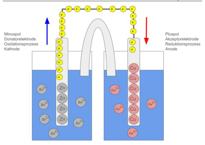
Zinkatome gehen in Lösung. Die dabei freiwerdenden Elektronen reduzieren die Kupferionen in der rechten Halbzelle zu elementarem Kupfer. Dies geschieht so lange, bis nennenwerte Mengen an Kupfersulfatlösung verbraucht sind.
