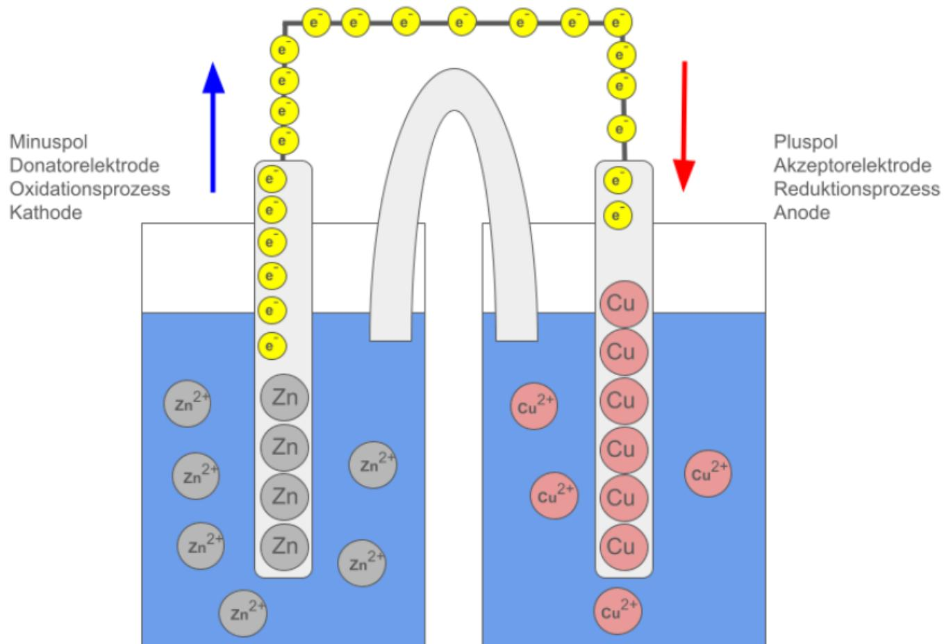
Zinkatome gehen in Lösung. Die dabei freiwerdenden Elektronen reduzieren die Kupferionen in der rechten Halbzelle zu elementarem Kupfer. Dies geschieht so lange, bis nennenwerte Mengen an Kupfersulfatlösung verbraucht sind.
