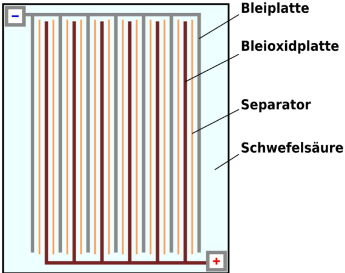
Das Potential einer solchen Zelle beträgt ca. 2,2V. Man kombiniert in einem Bleiakku für ein Auto sechs solcher Zellen, um auf eine Gesamtspannung von 12V zu kommen. Diese sechs einzelnen Zellen lassen sich auf folgendem Foto schön erkennen (sechs „Fächer“, sechs „Schraubdeckel“):
