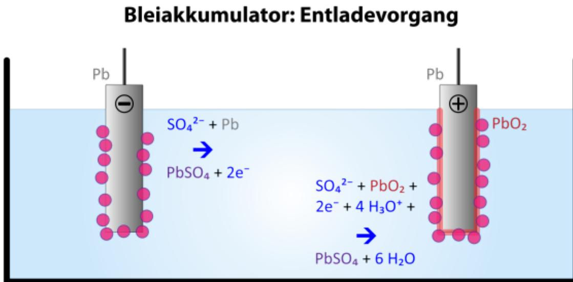
Zwei Bleielektroden tauchen in eine relativ starke (ca. 37%ige) schwefelsaure Lösung ein. An der Donatorelektrode (Minuspol) geht elementares Blei als Blei(II)sulfat  $\text{PbSO}_4$  in Lösung. Dabei werden pro Bleiatom zwei Elektronen an die Elektrode abgegeben:
