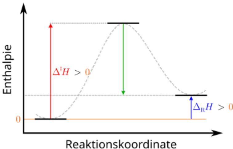
Aus Sicht des System ist bei einem exothermen Vorgang daher die Definition einer negativen Energiebilanz sinnvoll, bei endothermen Vorgängen entsprechend umgekehrt.
