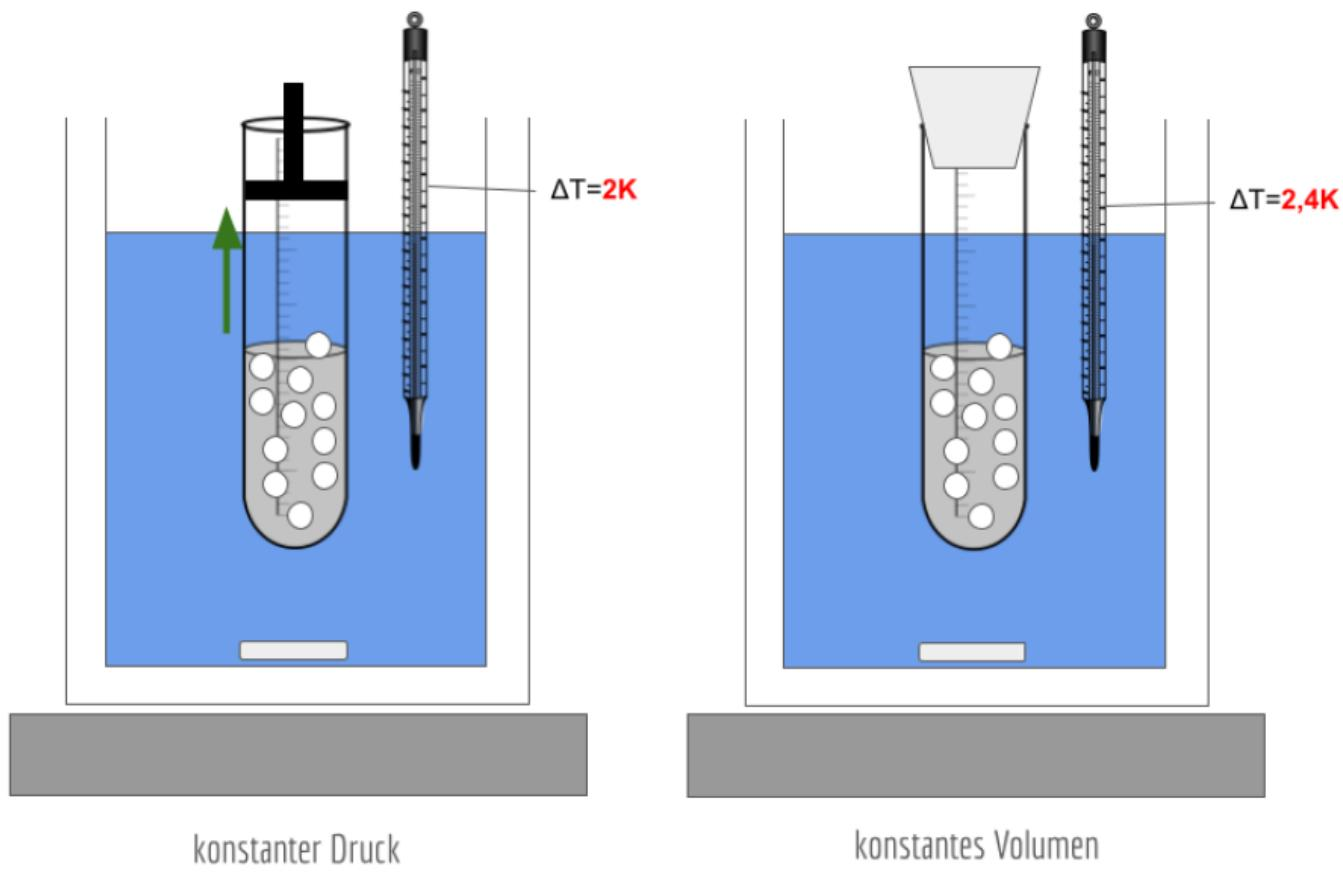
Bei konstantem Druck wird der Stempel durch das entstehende Gas nach oben geschoben. Bei konstantem Volumen misst man eine etwas höhere Temperaturdifferenz  $\Delta T$ .
