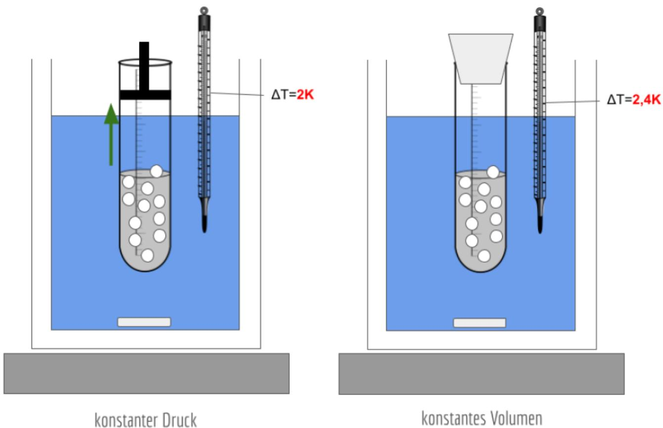
Bei konstantem Druck wird der Stempel durch das entstehende Gas nach oben geschoben. Bei konstantem Volumen misst man eine etwas höhere Temperaturdifferenz  $\Delta T$ . Also wird eine Teil der inneren Energie U in Form von Wärme und ein andere in Form von Volumenarbeit abgegeben.
